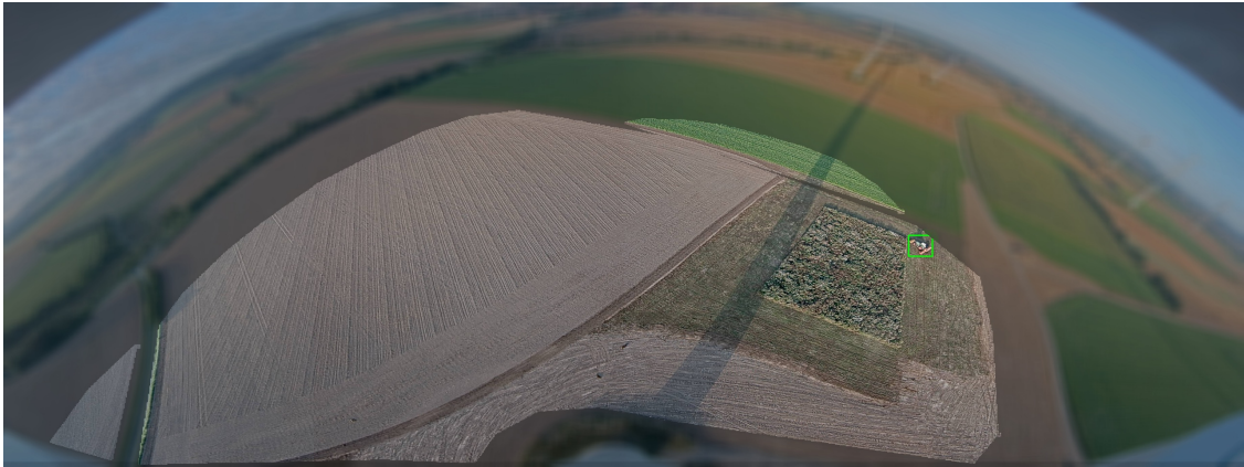
Abbildung 2: Sicht von FlexiBird um ein Windrad. Bereiche, die aufgrund zu großer Entfernung oder aus Datenschutzgründen nicht überwacht werden sollen, werden automatisch unkenntlich gemacht. Ereignisse in diesen Bereichen werden bereits vor Ort vom Computersystem ignoriert. In diesem Beispiel wurde die bewirtschaftende Landmaschine korrekt erkannt und lokalisiert. Die Lokalisation wird durch das grüne Rechteck angezeigt. Abschaltungsrelevante Ergebnisse werden an ein zentrales Webportal weitergegeben.
